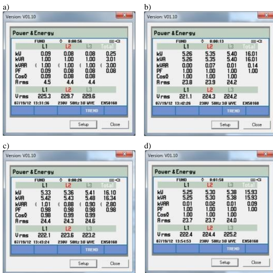
Rys. 2. Wyniki pomiarów mocy czynnej, biernej i pozornej (w fazach i całkowitych), prądów i napięć fazowych oraz współczynników mocy odpowiednio dla załączonych do sieci energetycznej: a) 3-fazowego odbiornika indukcyjnego, b) zasilacza UPS pracującego przy obciążeniu czynnym 100% P max , c) załączanych równoległe: UPS oraz odbiornika indukcyjnego, d) załączanych równoległe: UPS oraz odbiornika indukcyjnego po wprowadzeniu nastaw kompensacji mocy biernej
