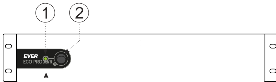
➔ Sygnalizacja akustyczno-optyczna określonych stanów pracy UPS-a
