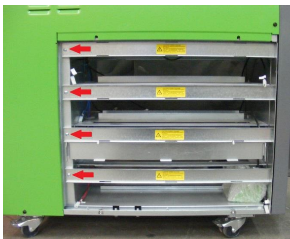
Fot. 2. Demontaż blokad akumulatorów
