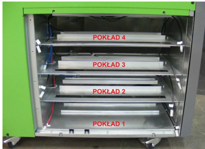
Fot. 3. Rozmieszczenie pokładów akumulatorów
